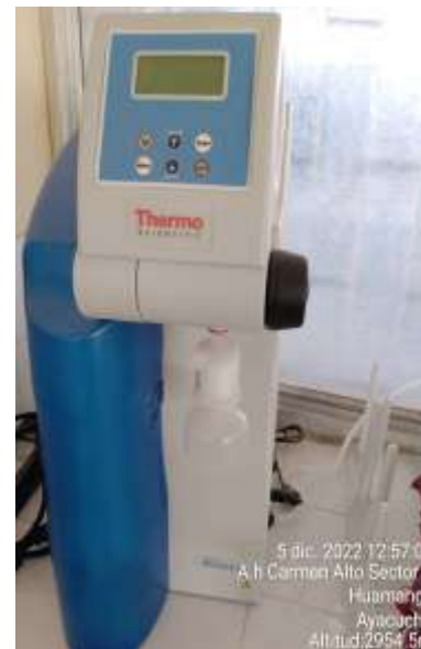
EQUIPO DE GENERADOR DE AGUA ULTRAPURA
