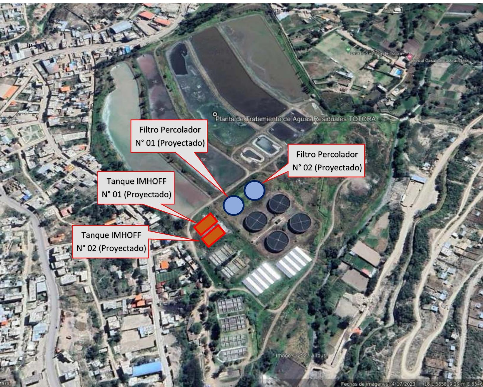
Como se puede observar en la ilustración que antecede, el objetivo del IOARR en mención es la construcción de dos (02) Tanques IMHOFF, adicional a los 2 ya existentes, así como dos (02) filtros Percoladores a fin de que puedan coadyuvar a la infraestructura ya existente.
